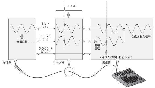
送信側では、元の信号「ホット (+)」に対して位相を反転した信号を「コールド (-)」に送ります。受信側では、「コールド (-)」の信号を位相反転し「ホット (+)」の信号と合成します。
