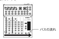
⑥ マスターコントロールとレベルメーターマスターコントロールは、各チャンネルから送られてくる信号全体のレベルを調整する部分です。 具体的には、ステレオコントロール、C-R/PHONES コントロールがあります。レベルメーターは、ST バスに流れる信号のレベルを LED で表示します。
