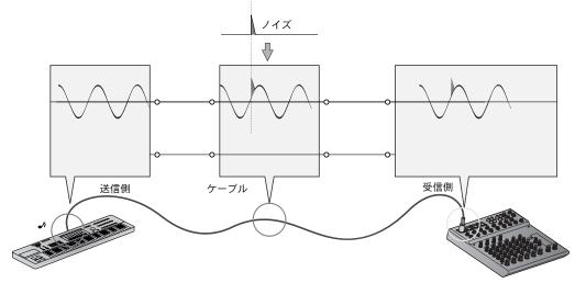
アンバランス方式は、バランス方式のグラウンド (GND) をコールド (-) と兼用にして、ホット (+) とグラウンド (GND) で信号の受け渡しを行なう方式です。バランス方式のようにノイズを取り除くことはできませんが、通常この方式で使用される機器は、受け渡す信号レベルが高いためアンバランス方式で十分対応できます。DI(\*) などで信号をバランスに変換することもできます。
