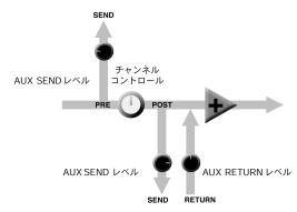
外部エフェクターのためのポストフェーダー信号 AUX2 センド信号はリバーブなどの外部エフェクターに送られ、そのエフェクターから AUX リターン端子などに送り返され、ステレオバスへミックスされます。チャンネルコントロールの設定がセンドレベルに影響を与えるので、エフェクターへ送られる AUX 2 ポストフェーダー信号のレベルもそれにともなって変化します。
