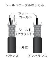
シールドケーブルは左図のようにホット(とコールド)を 金属の網状のもの(シールド)で覆った構造をしていま す。信号を受け渡しするときに、シールドがバリアとなっ て、外部ノイズから信号を保護します。
