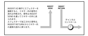
INSERT I/O 端子は、TRS 型のフォーン端子を利用した双方向の接続となっています。接続には下図のような特殊インサートケーブルが必要です。 別売りのヤマハインサートケーブル YICO25/050/070 などをご使用ください。
