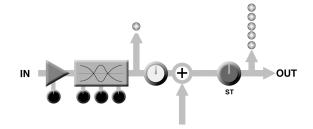
ミキサー内のヘッドアンプからマスターコントロールにいたる各段階で、信号に多少ノイズの少ないクリアな音質を作るために、入力された信号をミキサー内のできるだけ早い段階で増幅することがポルトです。つまり、ヘッドアンプに設けられたゲインコントロールで、信号のレベルをでもが大切です。ただし、クリッピングを掲幅するといっても、クリッピングを起くがして音が歪んでしまって「クリッピング直前まで」増幅させることがコツです。
